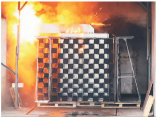
40kA/1s atviro lanko bandymo metu
